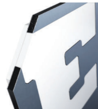
FS6 GRAFIKA ZLICOWANA: element graficzny wycięty w płycie kompozytowej i wypełniony plexi opal
